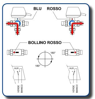
Idonea per acqua o liquidi compatibili con **PTFE** ed **EPDM**. Prima dell' installazione assicurarsi che il circuito idraulico sia pulito da corpi solidi come residui di saldatura o di filettatura.
