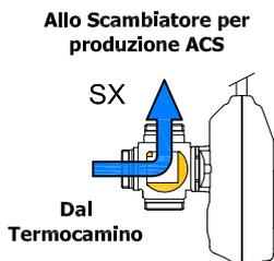
POSIZIONI DI AGGANCIAMENTO DEL MOTORE ALLA VALVOLA NEL CASO DI SMONTAGGIO DELL'INSIEME MOTORE - VALVOLA 3 VIE, RIMONTARLI RISPETTANDO LE POSIZIONI IN FIGURA
