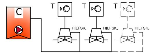
Die Servomotoren sind mit potentialfreiem Hilfsmikroschalter zum Pumpen-Stoppen ausgestattet und sie erlauben es, den Betrieb der Pumpe und des Brennerkessel, nur wenn mindestens ein Kugelventil vollständig geöffnet ist.
